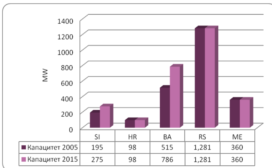
Слика 39: Капацитет хидроелектрана >10 MW по земљама 2005 - 2015. године (MW)
